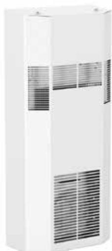
Si el aire está muy contaminado por polvo o líquidos, los intercambiadores aire-aire son la opción más recomendada. El circuito de aire exterior está aislado del interior para crear una separación hermética entre el interior del cuadro eléctrico y las condiciones ambientales. El uso de un intercambiador de calor aire-aire requiere una temperatura ambiente constantemente inferior a la temperatura necesaria en el cuadro eléctrico.
